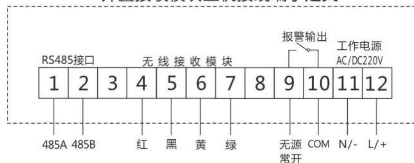
外置接收模块主机接线端子定义
